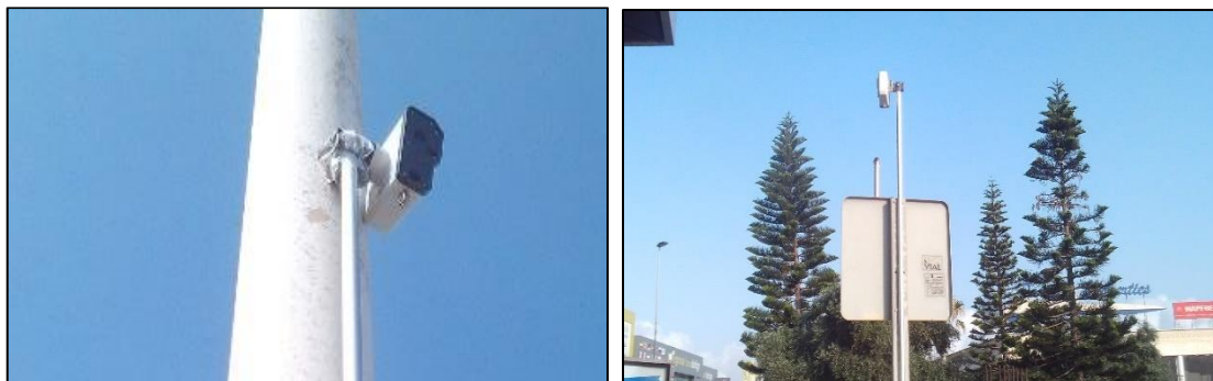
Cámaras COUNTcam2 montadas con el mástil en farolas o señales. Fuente: elaboración propia.
