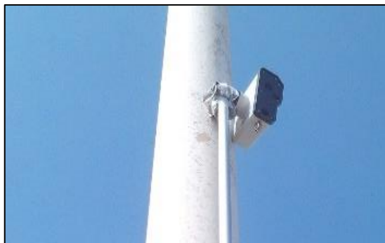
Cámaras COUNTcam2 montadas con el mástil en farolas o señales. Fuente: elaboración propia.
